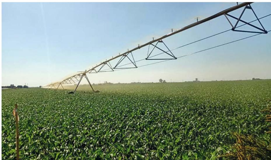
Foto 1 Operazione di fertirrigazione con acqua e digestato microfiltrato attraverso sistema di irrigazione lineare ad ali traslanti (rainger)
