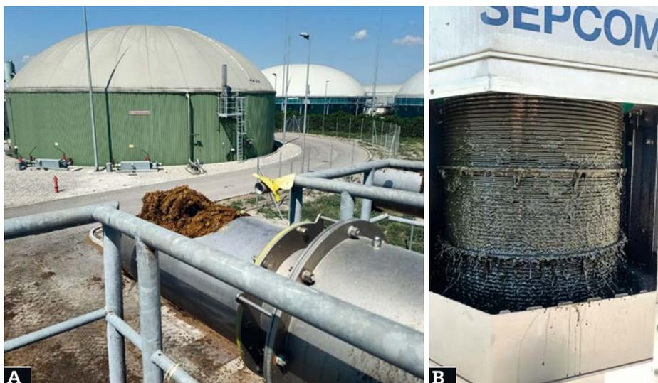
**Foto 2 A e B** Il trattamento del digestato per l'impiego in fertirrigazione è consistito nella separazione solido liquido con vite elicoidale orizzontale, seguita da microfiltrazione con attrezzatura innovativa
